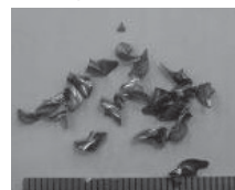
細かく分断された切りくず Short, broken pieces
